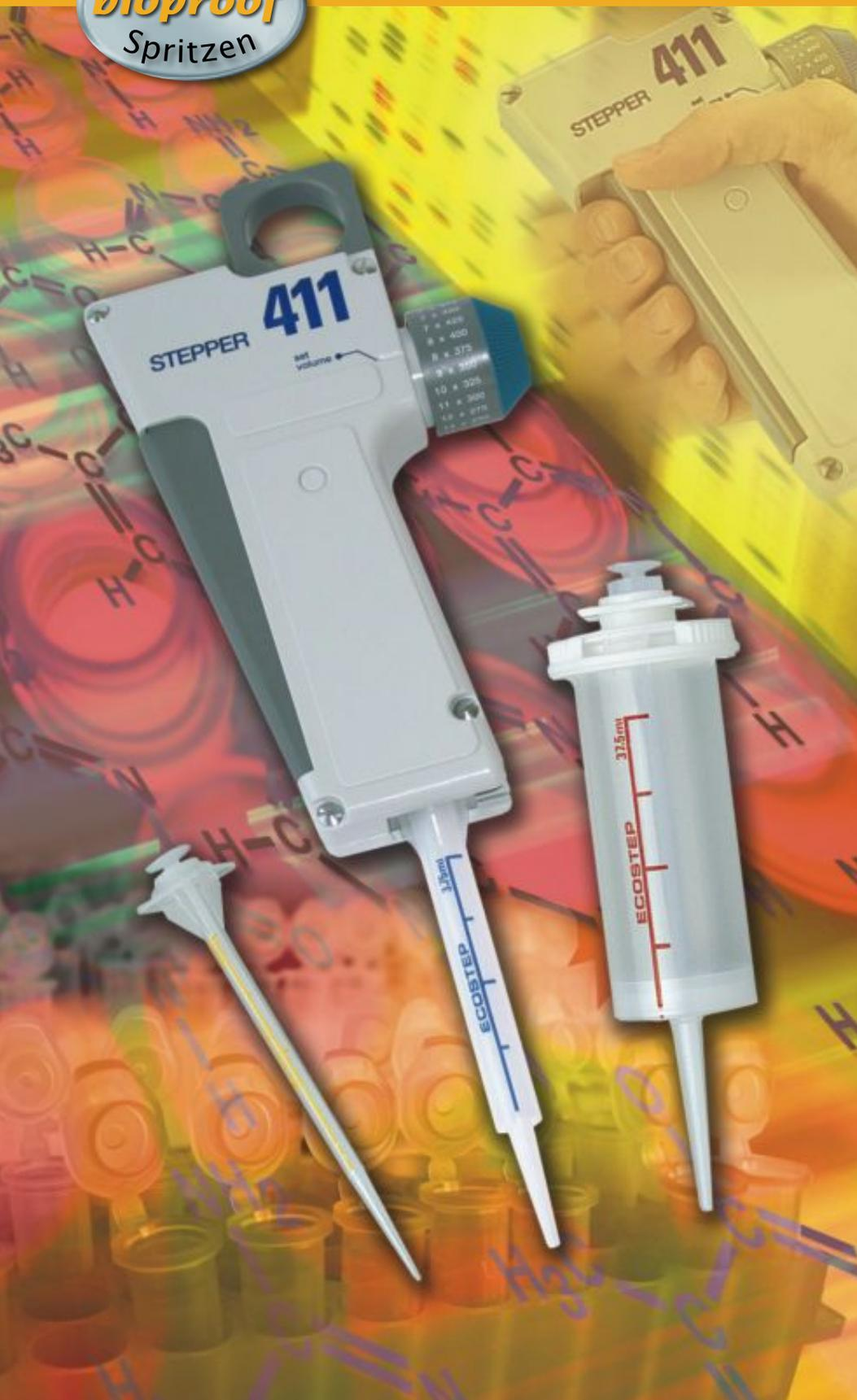
Höchst komfortable Pipette für ein verlässliches Seriendosieren in einem Volumenbereich von 10 bis 5000 µl. Die einmalige Vier-Fingerdruck-Funktion entlastet den Daumen. Sorgfältig ausgewählte Materialien bieten beste Schockresistenz. Kompakt einfache Form des Gehäuses verringert interne Kontamination. Grosse Auswahl an 53 verschiedenen Volumens; bis zu 73 Dosierungen pro Füllung.
